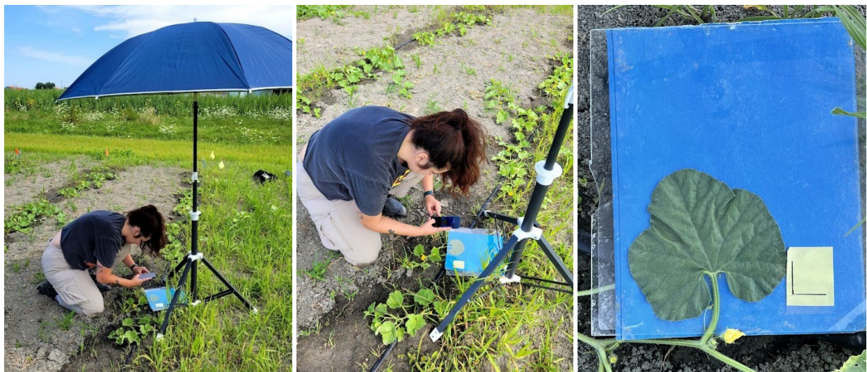
Figure 5. Dispositif utilisé pour la prise de photos afin d'évaluer la phytotoxicité des applications d'huiles minérale et végétale et du cuivre. Crédits : Sandrine Corriveau-Tousignant (CÉROM) et Virginie Simard (CÉROM).
